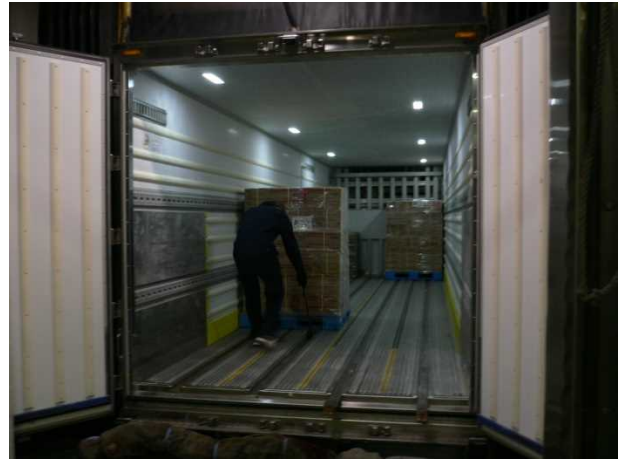
パレットローダを使用した荷役作業の状況
